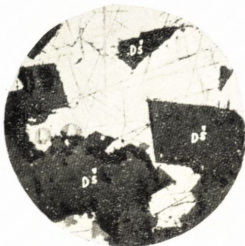
Obr. 3. Metakryštály dolomitu (Dš — šedý), zatláčajúceho galenit (biely). Zonálne usporiadané relikty galenitu v dolomite; A — anglezit. Nábrus, zväčš. 116×.
